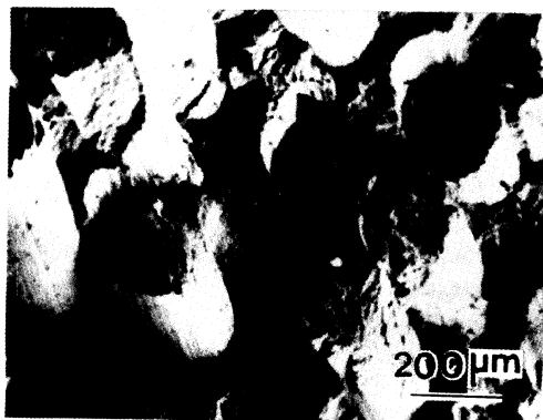
图 6 W 丝束增强 Zr_{55}Al_{10}Ni_5Cu_{30} 非晶复合材料拉伸后的断面形貌
