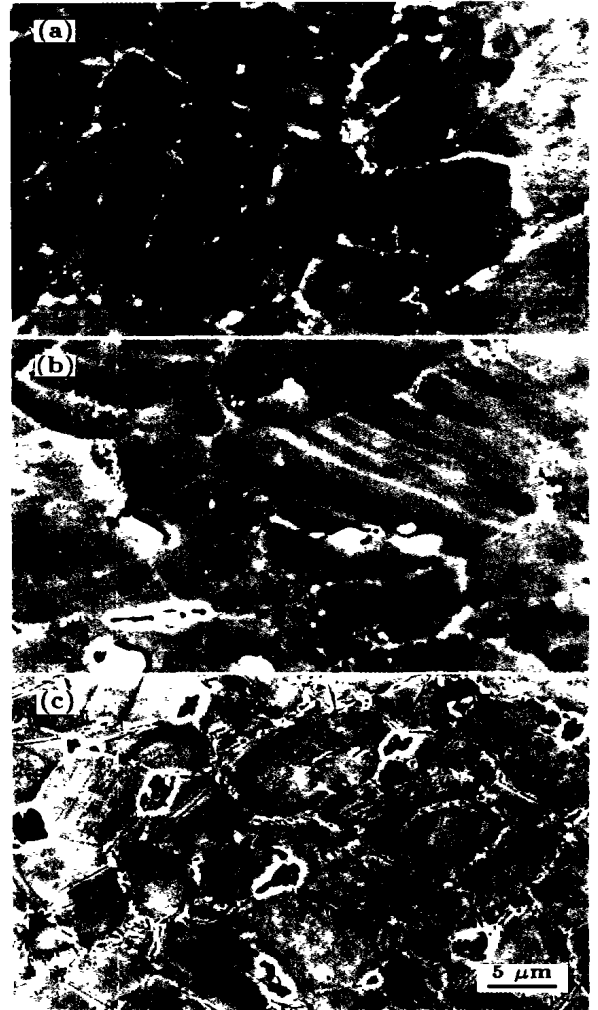
图 4 持久试样纵向剖面二次电子像
