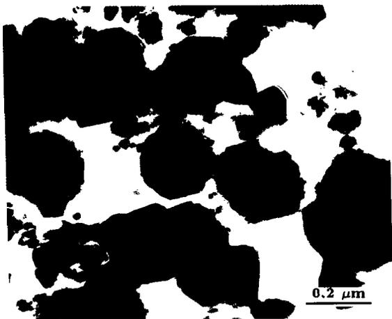
图 1 亚微米 SiC 粉的形貌
