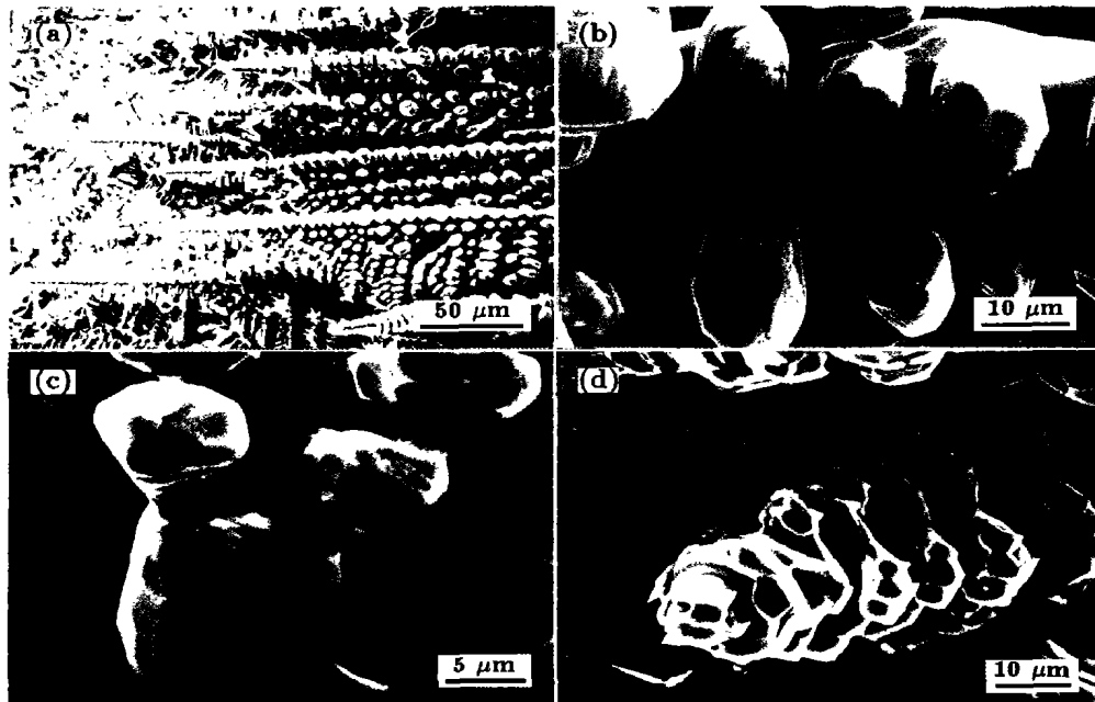
图 7 Ti-17Al-2C 合金定向凝固试样中棱面枝晶状初生 TiC
