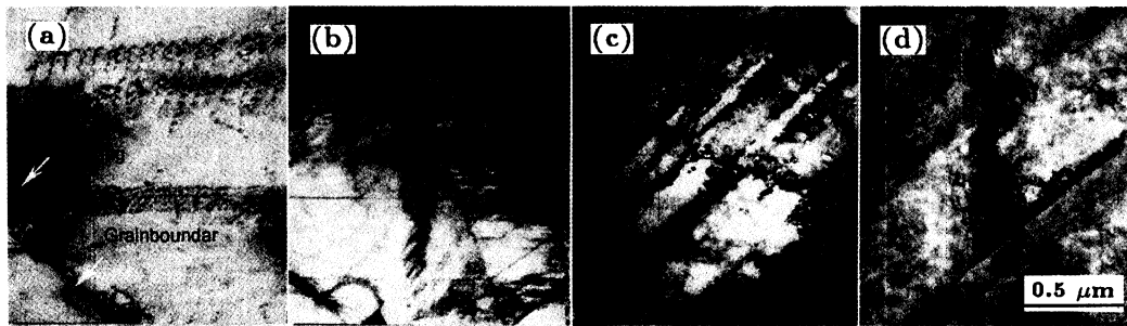
图 8 变形晶粒内部的孪晶和位错形态
