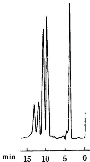
图 1 O-片呐基 N-苯基甲磷酰胺在柱 II 上的分离
