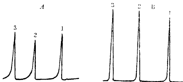
图3 柱后改装前后三组分色谱图(A.改装前, B.改装后)
