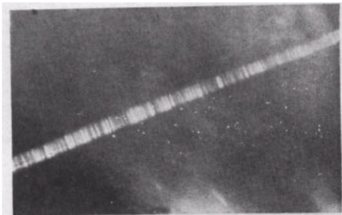
图 3 单根碳化硅纤维 ×500 反射 (经 1150°C 还原气氛处理后)
