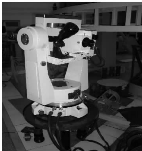
图 1 高速摄影机外观 Fig. 1 The photo of 70 mm HSPC system
