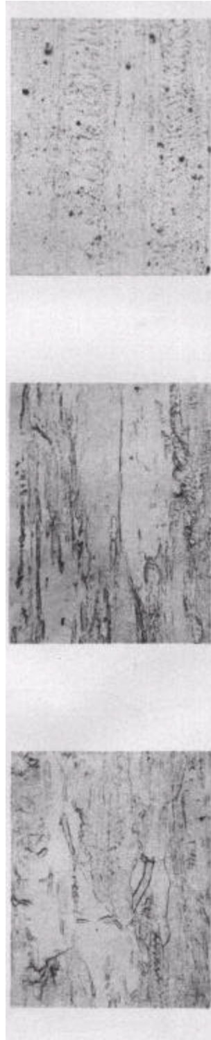
图 5(b) 立方取向镍铁合金经过 70%冷轧压延率
