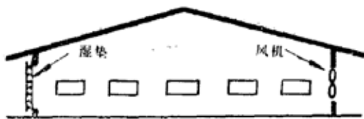
图6、带垂直湿垫的湿垫和风机系统
