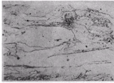
圖 2. 冷軋压下率 98.8% 純鐵显微組織 (5% 硝酒精, 放大 100 倍, 下同)
