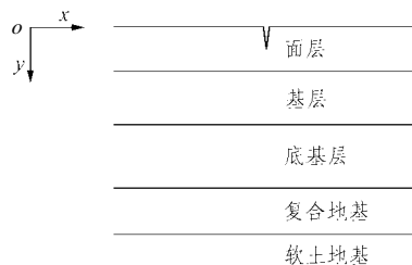
图 3 表面裂缝结构模型图
