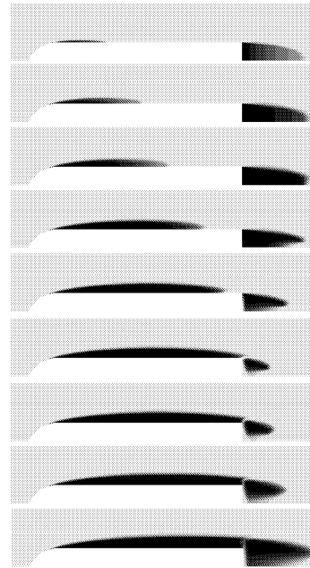
图 9 U_{\infty} = 60 \text{ m/s} 时射弹的空泡发展过程
