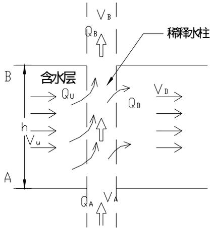
图 1 有垂向流时孔中水的运动示意图
