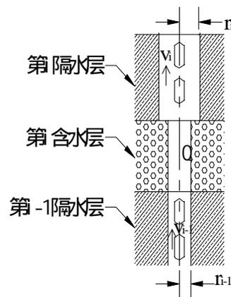
图 4 涌水量或吸水量测定示意图
