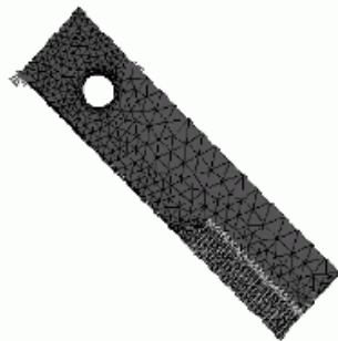
图3 刀片施加约束和施加载荷
