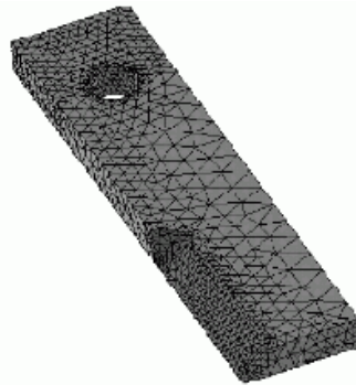
图2 刀片有限元网格划分
