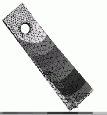
图4 刀片变形及节点位移
