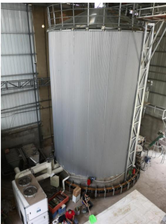
平台具有: 新型连续式谷物烘干机、谷物烘储调一体仓、谷物冷却机、循环式进料装置、除尘系统、智能控制系统等设备, 可实现不同水分的稻谷连续自动烘干与烘储调一体化, 降低烘干稻谷的破碎率、爆腰率和烘干成本, 烘干后稻谷储藏的化学熏蒸药剂零使用及低温与准低温储粮, 有效提升稻谷的烘干品质和储藏品质, 及质量安全水平。
