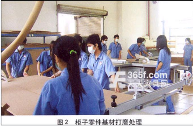
图2 柜子零件基材打磨处理
