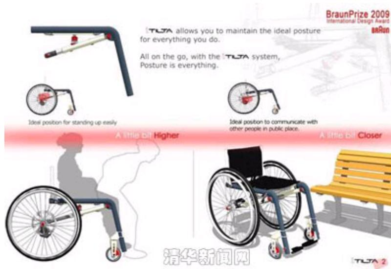
iTILTA是一台特殊结构设计的电动轮椅，给轮椅使用者创造了一个全新的使用体验，充分满足使用者各种行为体态所需，轻量化架构和可折叠机构适应各类现代化城市生活要求。iTILTA系统是基于弹簧机构和气压杆机构的简单组合，可以提供使用者想要的各种身体姿态，座椅高度及倾角，满足日常行为所需。iTILTA的三个最主要的解决问题是：抬高使用者视线及够取高处物品/帮助使用者便捷安全地上下轮椅/增进使用者与其他人的平等交流。总之，iTILTA提供轮椅使用者一种“姿态就是一切”的使用体验，同时赋予医用机械产品友好的实用主义美学。
