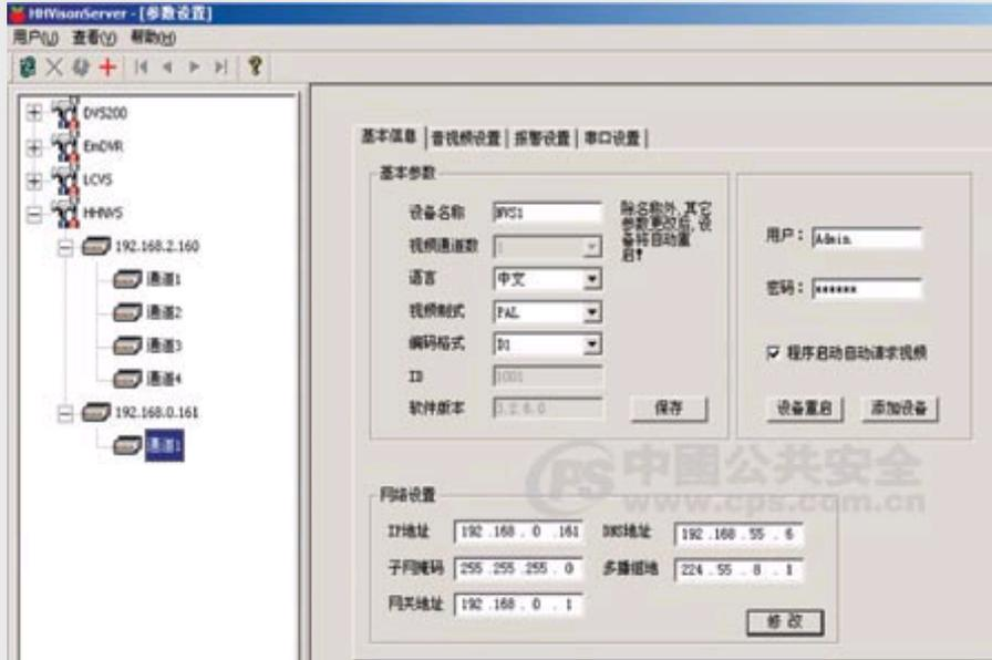
HHVision Server应用服务器软件安装于网络监控管理系统的服务器端，配置和管理整个网络监控系统的各个设备参数以及客户端的各种信息。
