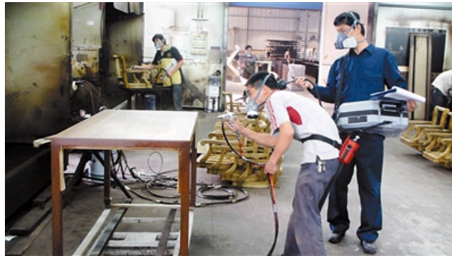
科研人员利用便携式红外气体分析仪进行喷漆作业危害控制技术研究
