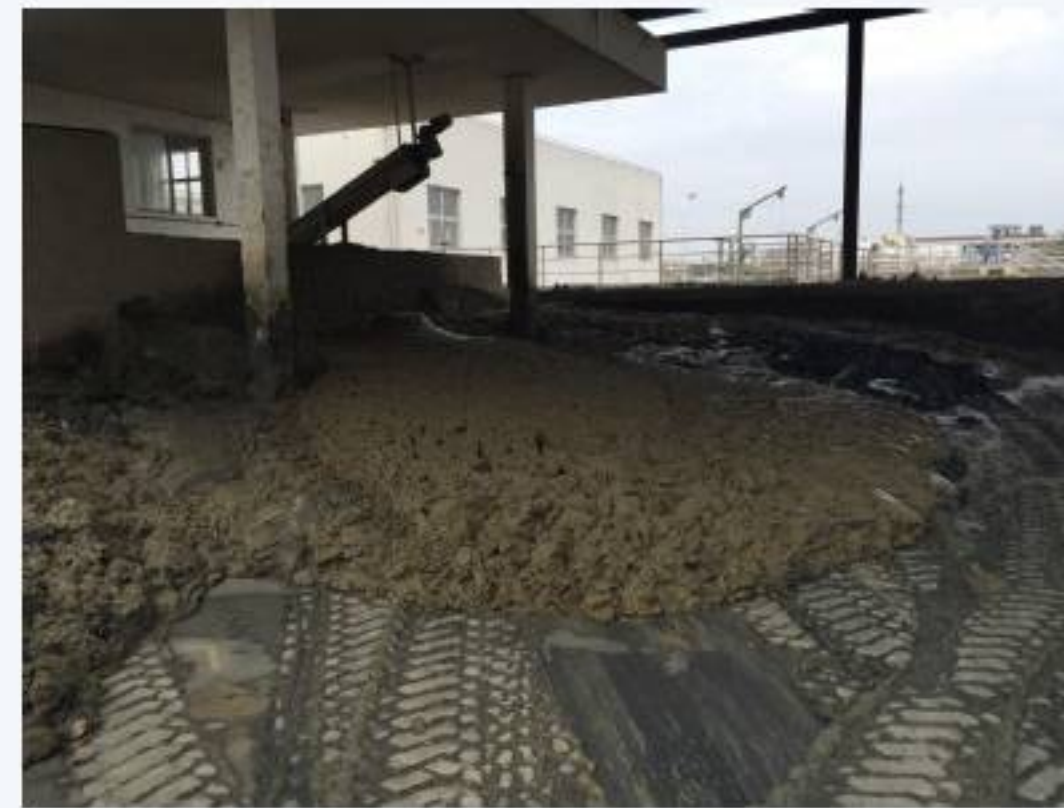
上海市杨树浦水厂泥水分离后的干化污泥（含固率30~40%）
