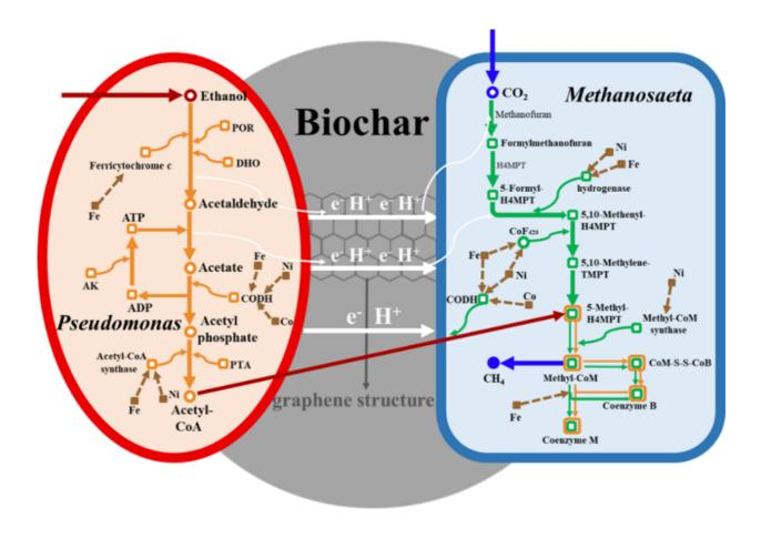
厌氧消化系统中导电碳材料潜在的DIET机制 (Chemical Engineering Journal 406, 126833, 2021)
