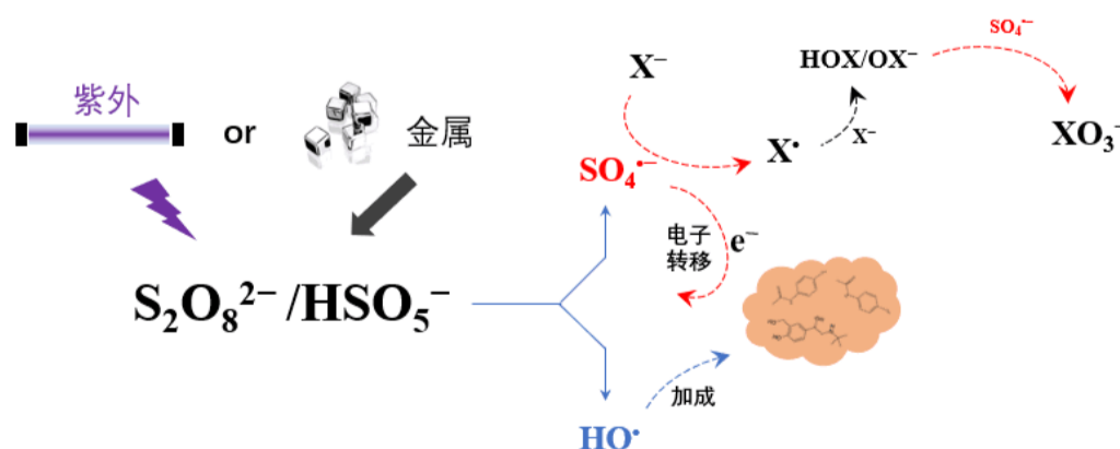
图2. 硫酸根自由基的氧化机理及其与卤素离子的作用机制
