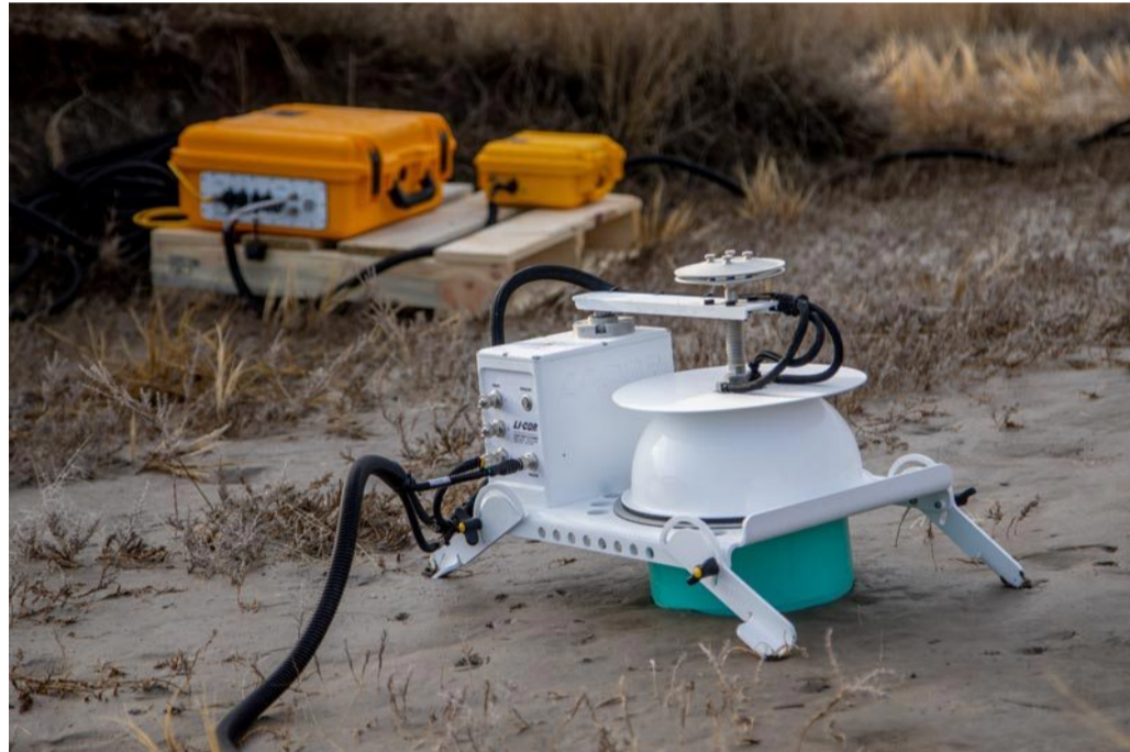
图: 美国LI-8250多通道土壤碳通量长期自动测量系统。浅绿色的部分为测量的土壤环
