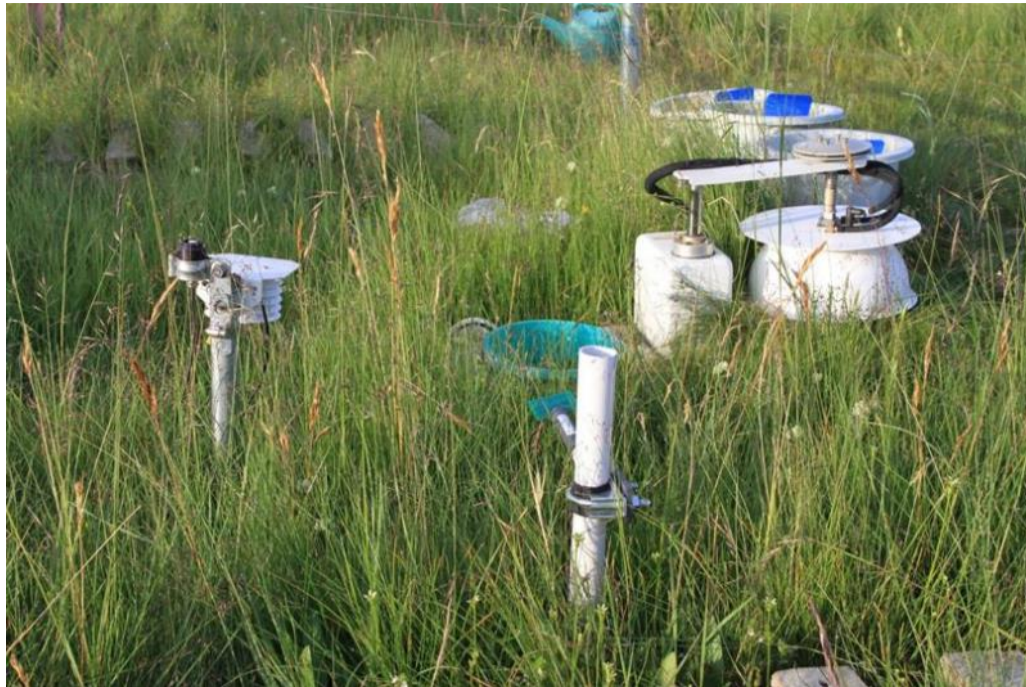
图：团队在青海海北高寒草地生态系统国家野外科学观测研究站利用多通道土壤碳通量长期自动测量系统测定土壤呼吸
