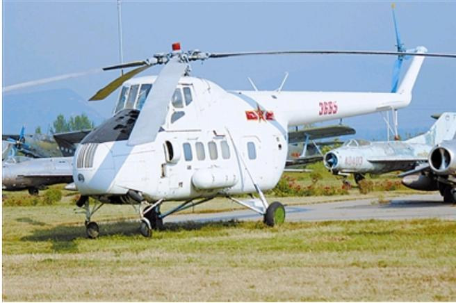
直-5是我国哈尔滨飞机制造公司生产的单旋翼活塞式直升机，是新中国生产的第一种直升机。
