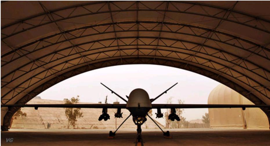
资料图：美军装备的MQ-9无人侦察机可携带10余枚制导炸弹，既能实施侦察任务也能进行空中打击。
