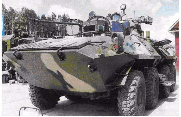
1994年，俄罗斯研制出BTR-90(8×8)装甲运输车，但至今尚未正式生产。该车的装甲防护能力得到较大增强，车体正面可防14.5毫米枪弹，车体底甲板为V形结构，增强了对反坦克地雷的抵御能力。战斗全重增加到17吨，并配备了170毫米口径的火箭筒发射器，增强了远距离对坦克作战的能力。
