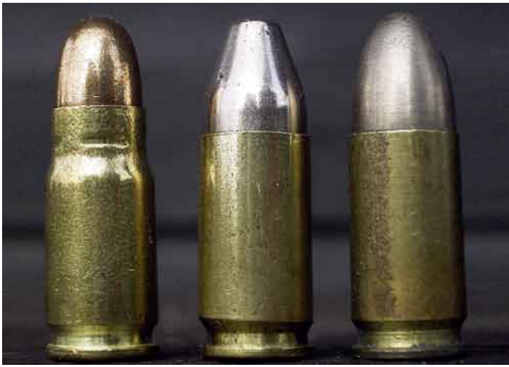
三种德国早期典型的自动手枪弹。从左至右分别是：7.65×21mm卢格手枪弹、采用锥形平顶弹头的早期9mm巴拉贝鲁姆手枪弹、采用弧形圆头弹头的08型9mm巴拉贝鲁姆普通弹
