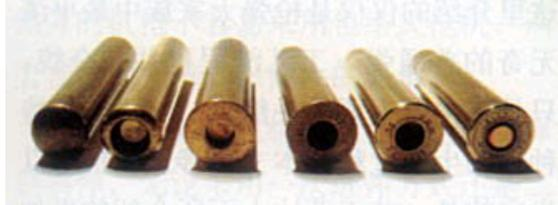
黄铜弹壳底部的加工流程与文中所述基本类似。从左至右分别是：经过二次引伸的铜盂、打凹、平底并冲底火室、冲传火子L、车底、装入底火
