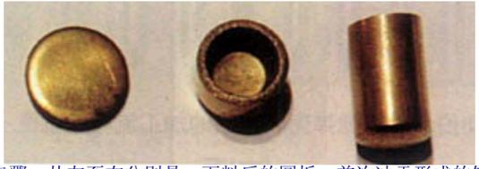
黄铜弹壳制造时的初始步骤。从左至右分别是：下料后的圆板、首次冲盖形成的铜盖、一次引伸后的铜盖
