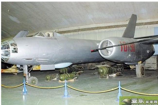
轰-5是我国哈尔滨飞机制造厂生产的轻型喷气式轰炸机。在设计中,设计人员以前苏联生产的伊尔-28为基础,根据我国航空工业的实际情况和使用部队的具体要求做了大量技术改进。
