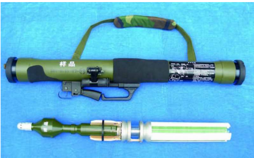
DZJ08式80mm单兵多用途攻坚弹武器系统由发射具(上)和攻坚弹(下)两部分组成
