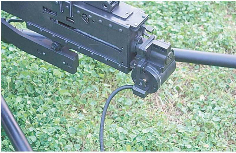
CS/LM6型0.50 英寸重机枪枪尾留有接口，可安装电击发装置
