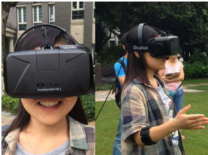
操作者穿戴脑电耳机、臂环和虚拟现实眼镜
