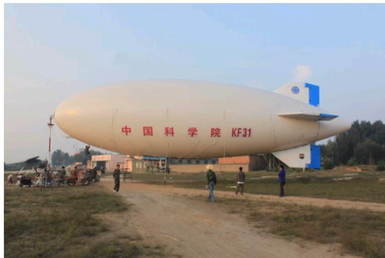
2009年8月28日至9月1日,中国科学院光电研究院气球飞行器研究中心在山西大同成功地进行了KF31飞艇电力推进和汽油发动机动力推进飞行试验,验证了多项关键技术,电力推进飞艇为国内最大。
