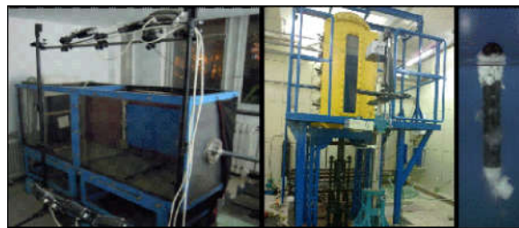
图 1 水平与垂直发射机理性实验系统
