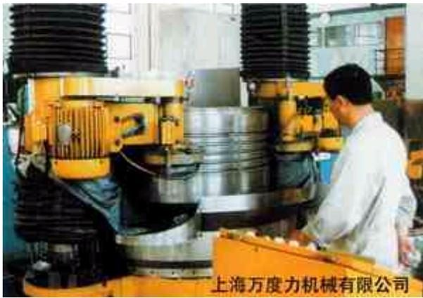
增压器的透平长期在主机排气的高温工况下高速运转，由于承受高的热负荷，透平叶片极易腐蚀、折断，严重时增压器烧毁。同时增压器维护不当会产生大量的油垢、污垢，影响增压器转子的动平衡。因此对增压器的修理要求十分严格，要保证装配间隙，满足动平衡要求。
