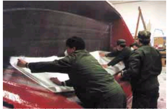
天津吉尔曼船舶有限公司的员工正在铺设玻璃纤维毡
