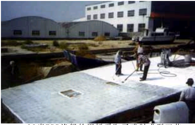
33米FRP渔船的甲板采取了喷射成型工艺
