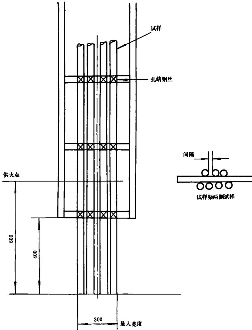
图 I4 试样架上试样安装方法
