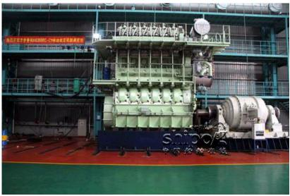
2月28日,由洋普重机与MAN联合开发的世界首台6S35MC-C9船用低速柴油机 顺利通过台架试验。各项性能指标均得到了船东、船检、MAN专家的一致好评。 该机交付给广西长荣海运有限公司,用在798标箱的船上。此机型是在原 6S35MC7的基础上进行了9大技术改进,实验结果,各项性能指标均优于 6S35MC7, 而且转速更低,油耗更低。该机型将取代老款6S35MC7及中速柴油 机,广泛运用于6000吨-30000吨的各类船型,市场前景非常广阔。
