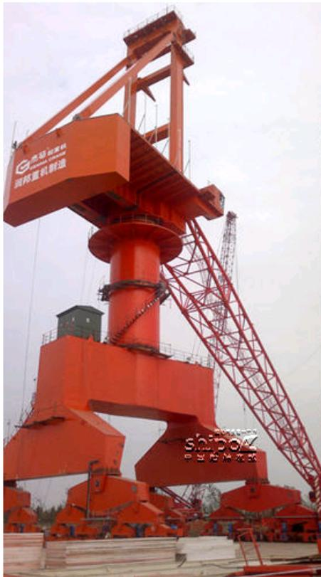
日前,由润邦重机生产、制造的“杰马”品牌250吨单臂架门座式起重机顺利完成调试,即将进行型式试验。作为目前国内较大吨位的单臂架门座式起重机,该门座机项目的调试成功,标志着润邦重机已完全具备大型门座机的建造及安装调试能力。
