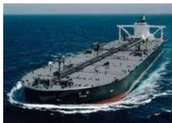
30万吨超大型油船船体总长333.5米, 相当于35辆5吨“解放”牌卡车首尾相接的长度, 而站在一栋每层高为2.6米的21层楼, 你才能够得着30万吨驾驶室上方雷达桅的底端。30万吨的总涂装部位面积也达到前所未有的98.4万平方米, 相当于170个足球场那样大。
