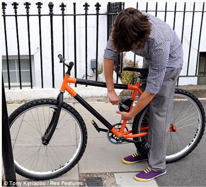
他发明的自行车外表看上去普普通通，但在锁车时，这款自行车便展露其不普通的一面，能够利用一个简易的机械装置让车架弯曲。
