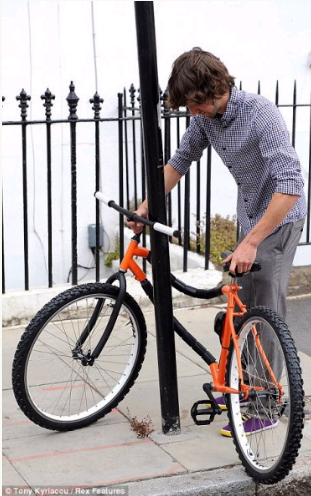
可弯曲的车架允许车子染过并扣住灯柱。
