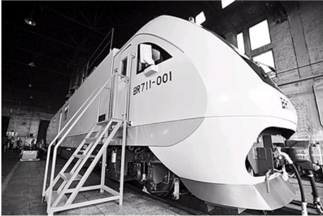
7月27日,我国首台高铁“救护车”——快速接触网综合作业车在中国北车北京二七装备公司完成组装、调试、实验。这种高铁“救护车”可以在高速铁路、城市快速铁路、曲线多的次要铁路运行,在坡道隧道内和冰雪灾害发生时,也可以快速、安全地加速和制动,迅速到达现场对高空接触网及桥梁进行检测和维修。此外,高铁“救护车”还可将故障线路内的列车牵引离开,疏通线路恢复运营。图为中国北车北京二七装备公司拍摄的我国首台高铁“救护车”。
