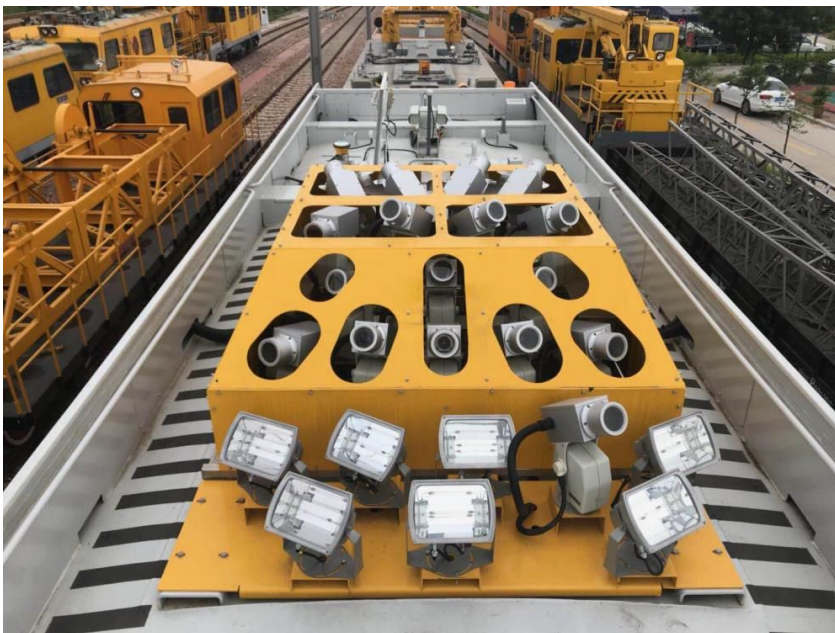
接触网悬挂状态检测监测装置(4C)系统高铁作业车车顶
