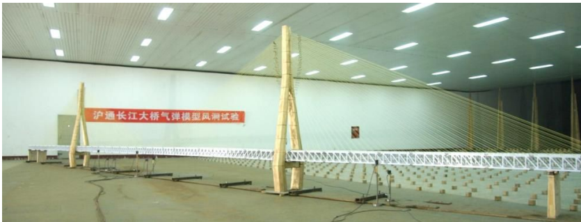
沪通长江大桥气弹模型风洞实验
