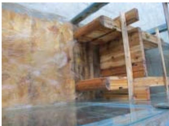
照片 1 峡口水闸扩建工程新闸断面模型布置
