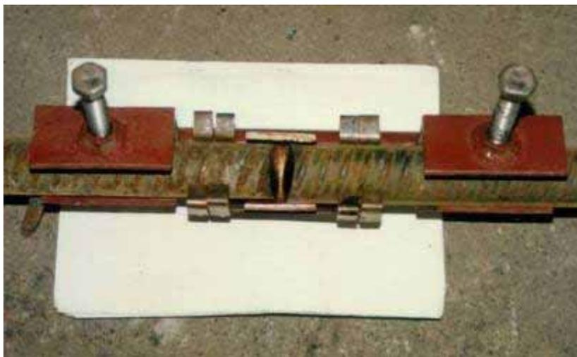
为保证接头部位的引弧质量和不失去熔化的金属液，可用铜模或直接用角钢模。
