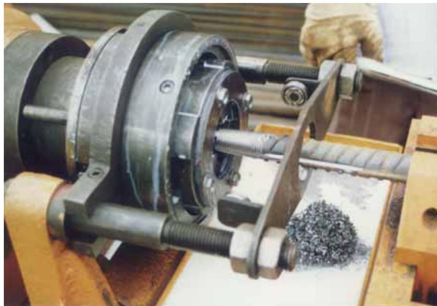
车削锥螺纹套筒连接最初采用较多，由于连接部位强度与母材不等强，最近被滚压锥螺纹、滚压或镢粗直螺纹连接方法替代。
