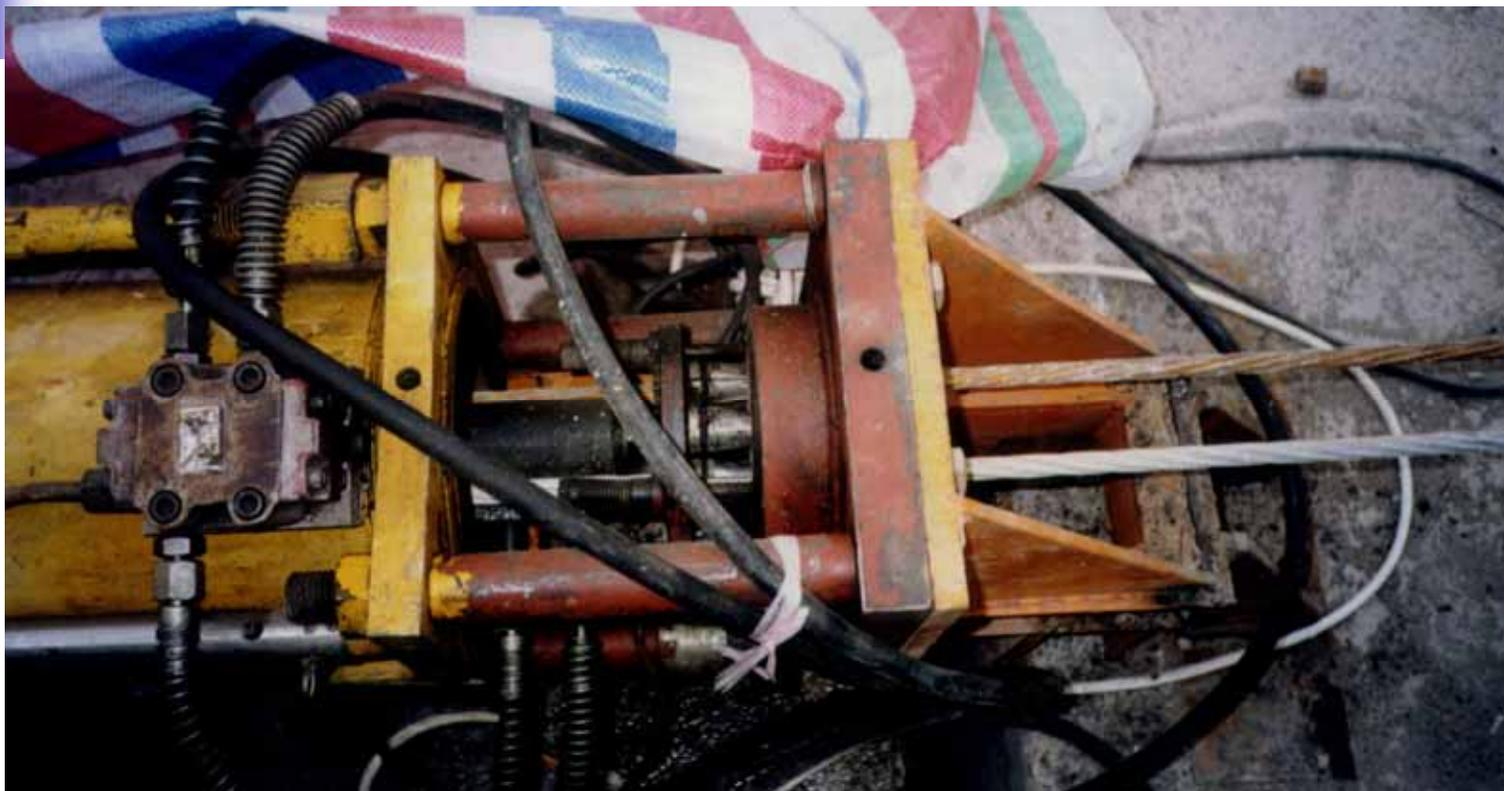
连续牵引千斤顶的前工具锚夹住钢绞线，完成后工具锚的退锚及倒缸。千斤顶的行程为300mm。
