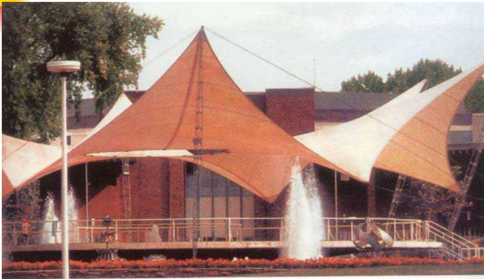
■德国一展馆庭院内的膜篷。六个鞍形膜单元环状拼合，中心设环索，单元膜外角用桅杆顶起，单元膜拼和角用钢索拉至地面
