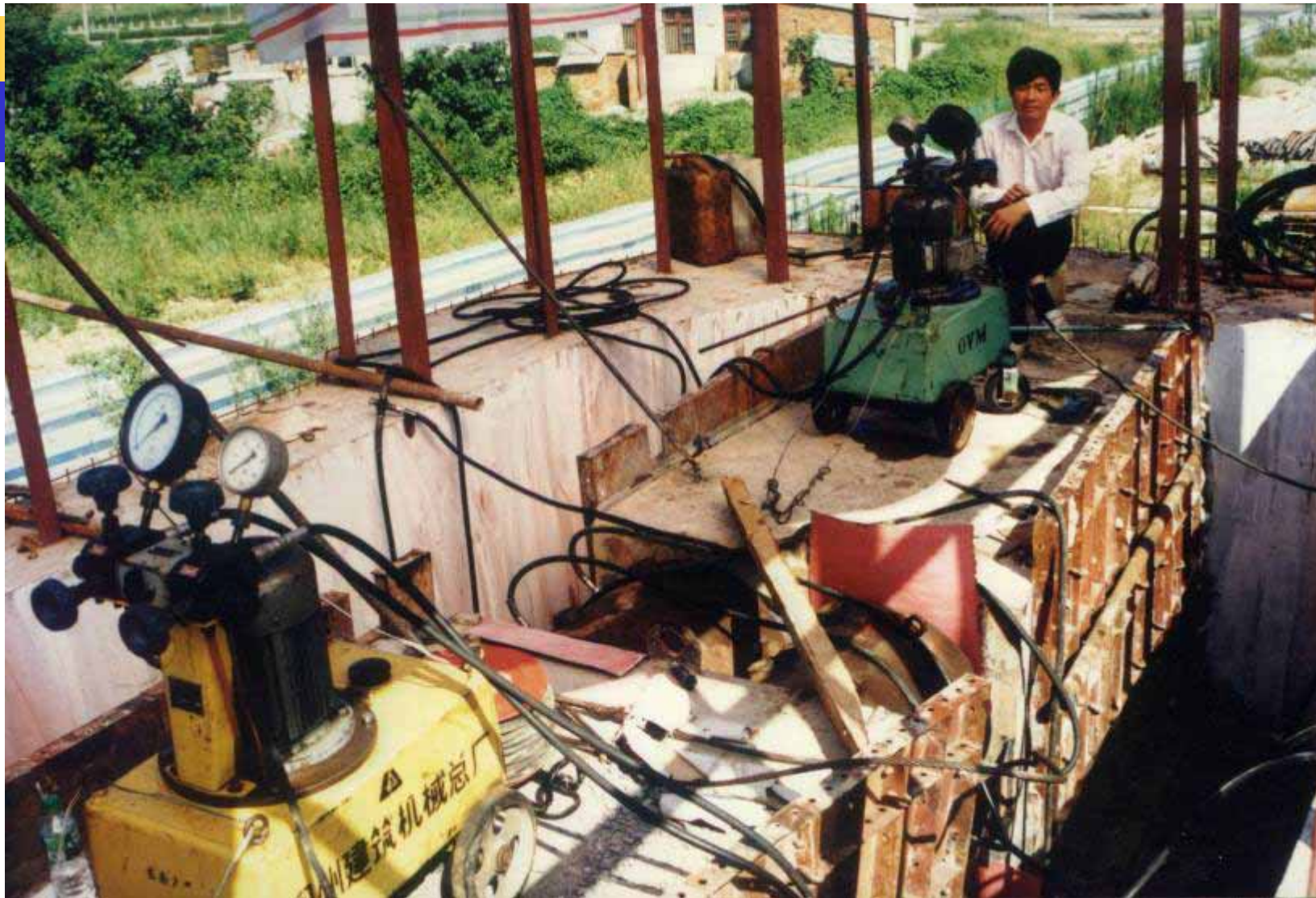
塔内用四台600t千斤顶联动加载，做极限破坏试验。
